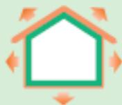
$$\text{外皮平均熱貫流率 } (\bar{U}_A\text{値}) = \frac{\text{単位温度差当たりの総熱損失量}}{\text{外皮表面積}}$$
